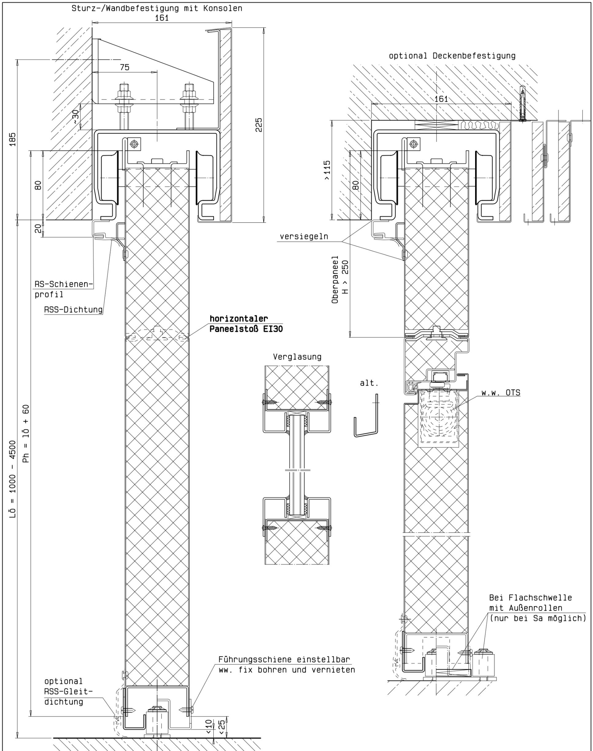
Bei Montage die wandseitigen RS-Profile zum Baukörper versiegeln. Paneelfugen (wandseitig), Auflaufprofile und unteres RS-Profil versiegeln
