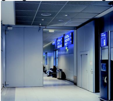
Bild 5: 2-flügeliges Drehflügelertor System Schröders mit Schlupftür, Tandemschließer und Anschluss an ein Deckenschott
